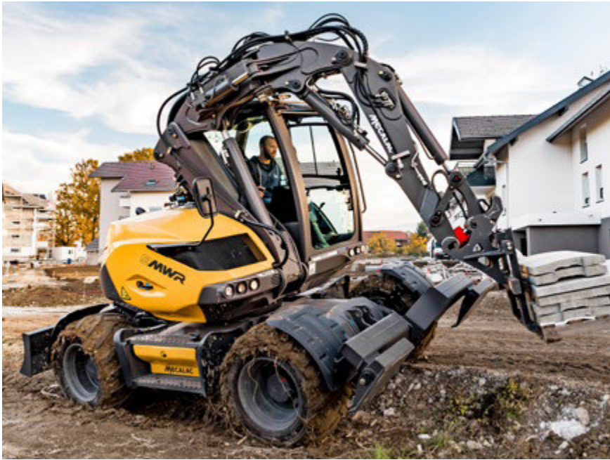
Wer einen Vielzweck-Mobilbagger (von Mecalac) hat, braucht keinen Radlader auf der Baustelle vorzuhalten.
