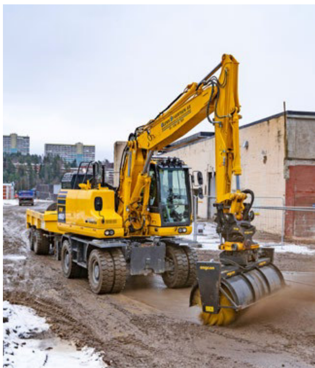
Vielseitig verwendbar sind Mobilbagger – hier der Komatsu PW160 mit Engcon-Tiltrotator – auch beim Arbeiten rund um die eigentliche Baustelle.
